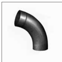
Objekt-csőív, 72°-os, RHEINZINK®-teraszcsatornához, hegesztett, egy hosszanti varrattal és felbővítéssel
